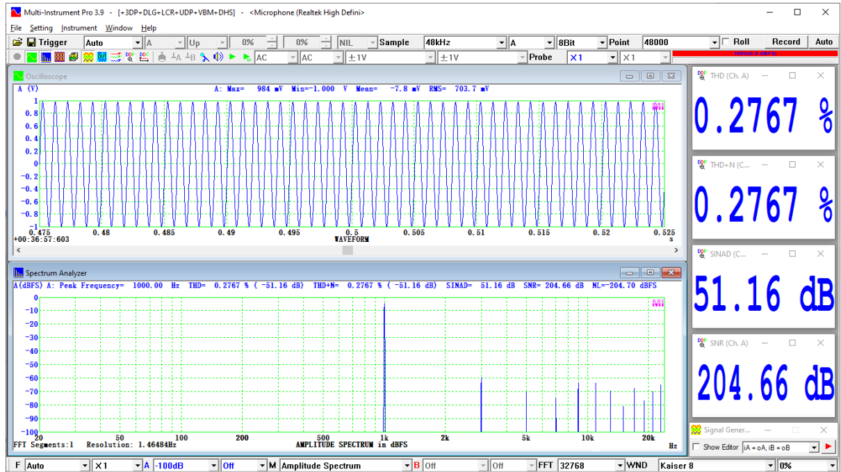
图 5 采样频率与信号频率之比为整数 (48000/1000=48) 时量化噪声变为谐波失真 (8 位)
